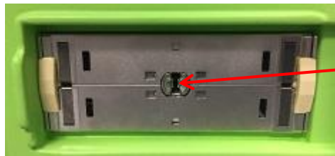
Figur 7: Låsehakk på probetilkoblingssporet
